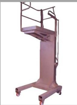
Ossature mécano-soudée 100% Inox
